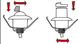
Зонирование LUXOMAT® PD9-1C (-GH)-FC при помощи линз-масок (в комплекте), для уменьшения или ограничения зоны действия датчика.
