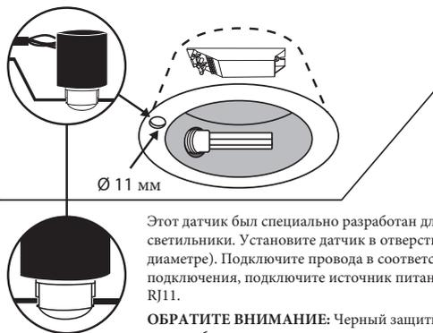
Этот датчик был специально разработан для монтажа в светильники. Установите датчик в отверстие (прибл. 11 мм в диаметре). Подключите провода в соответствии со схемами подключения, подключите источник питания через штекер RJ11.
