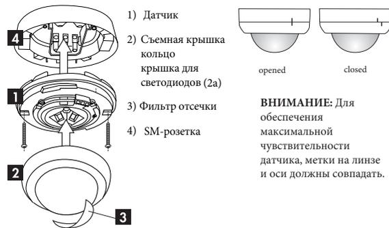
**ВНИМАНИЕ:** Для обеспечения максимальной чувствительности датчика, метки на линзе и оси должны совпадать.
