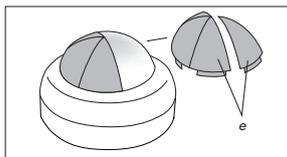
В случае, если площадь зоны использования модели LUXOMAT® PD4N-1C-C слишком большая или имеются нежелательные зоны, где датчик использоваться не должен, диапазон может быть уменьшен или ограничен за счет использования защитных линз-масок.
