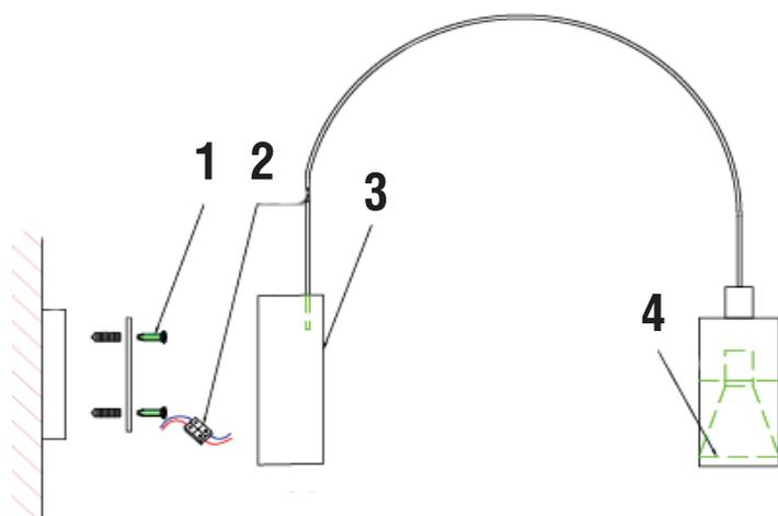
1. Просверлить ударной дрелью в стене отверстия для пластиковых дюбелей. Вставить пластиковые дюбели в просверленные отверстия. Привернуть с помощью саморезов крепежную планку.
