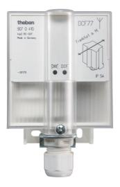
■ Радио контроль top2 RC устройств: для обеспечения хорошего радио сигнала не устанавливайте антенну в подвалах и вблизи распределительных щитов. Подключение 2-х жильным проводом (макс. длина кабеля 100 м). Антенну можно подключить максимально к 10 устройствам. Полярность, короткое замыкание и обрыв цепи отображаются на устройстве, что облегчает устранение неполадок.
