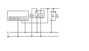
При выключении и выключении индуктивных нагрузок (например, реле, контакторов, подключенных на входе устройств) может потребоваться установка RC-фильтра.
