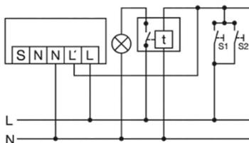
Параллельное подключение лестничного автомата.
