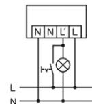
Стандартная эксплуатация с дополнительной функцией непрерывного освещения, включаемого с помощью внешнего выключателя.
