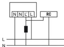
При выключении и включении индуктивных нагрузок (например, реле, контакторов, подключенных на входе устройства) может потребоваться установка RC-фильтра.
