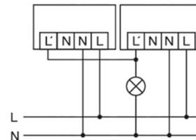
Параллельное подключение макс. 6 устройств.
