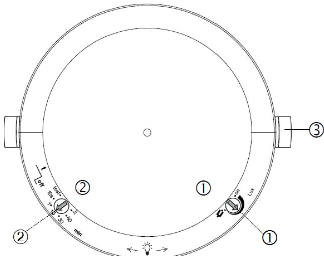
1 Настройка порога срабатывания по освещенности (Lux)
