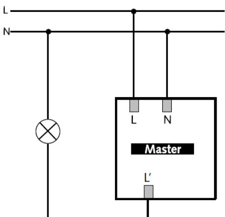
**Параллельное подключение нескольких датчиков**
