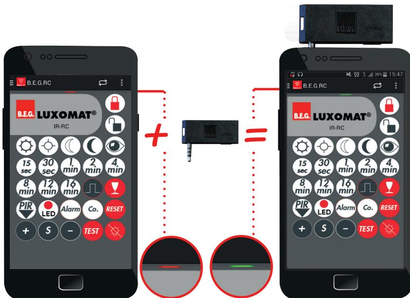
Шаг 4: Подключите IR-RC-Адаптер в разъем для наушников. Предупреждение: Иногда защитные чехлы не позволяют подключить адаптер полностью. Пожалуйста, убедитесь, что IR-RC-Адаптер подключен правильно.
