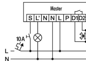
Стандартная эксплуатация с дополнительным управлением с помощью замыкающего выключателя. При необходимости освещение можно включить или выключить вручную с помощью кнопочного выключателя.
