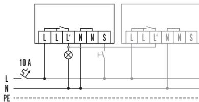
Стандартный режим с опциональным управлением с помощью замыкающего выключателя и параллельным подключением макс. 6 устройств.
