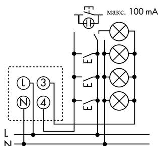
Так же к лестничному таймеру можно подключить **B.E.G. LUXOMAT® Indoor 180-SC**, максимальное количество датчиков 10шт.
