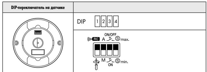
Индивидуальные настройки можно задать с помощью пульта дистанционного управления или вручную с помощью органов управления путем переключения многопозиционного переключателя DIP 1 (см. рисунок).
