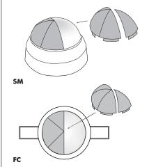
В случае, если площадь зоны использования модели LUXOMAT® PD4-M-1C-C-PS слишком большая или имеются нежелательные зоны, где датчик использоваться не должен, диапазон может быть уменьшен или ограничен за счет использования защитных линз-масок
