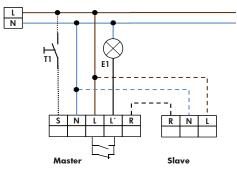
Т1 - Нормально открытый кнопочный выключатель для управления освещением в полуавтоматическом и автоматическом режимах.
