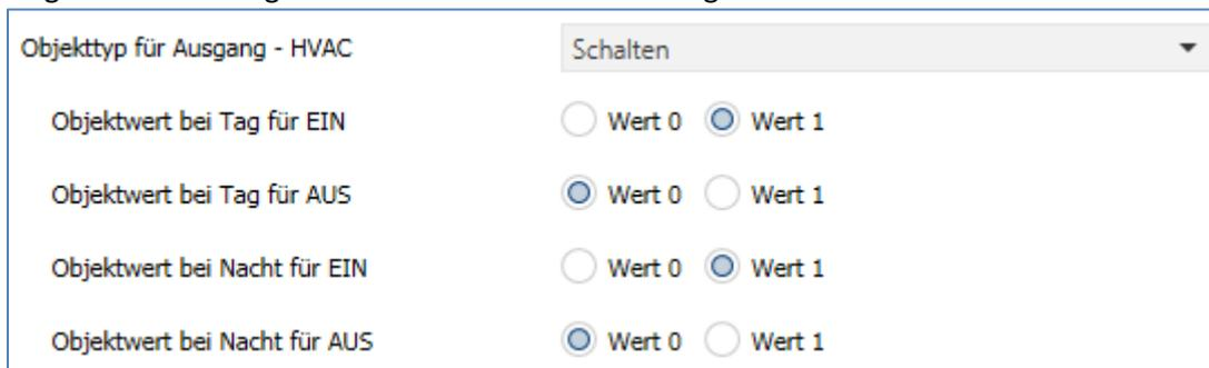
Abbildung 9: Einstellungen – Ausgangsobjekt Schalten (HLK)
