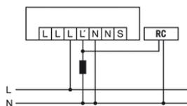
При выключении и включении индуктивных нагрузок (например, реле, контакторов, подключенных на входе устройства) может потребоваться установка RC-фильтра.
