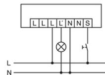
Стандартная эксплуатация с дополнительным управлением с помощью замыкающего выключателя. При необходимости освещение можно включать или выключать вручную с помощью кнопочного выключателя.
