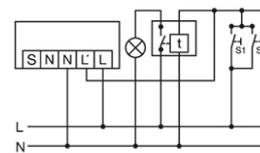
Параллельное подключение лестничного автомата.
