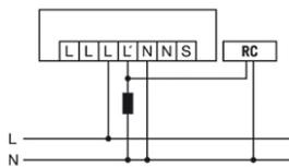
При выключении и включении индуктивных нагрузок (например, реле, контакторов, подключенных на входе устройств) может потребоваться установка RC-фильтра.
