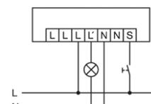
Стандартный режим: параллельное подключение макс. 10 датчиков движения.
