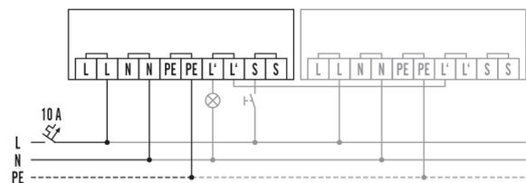
Стандартный режим с опциональным управлением с помощью замыкающего выключателя и параллельным подключением макс. 10 устройств.
